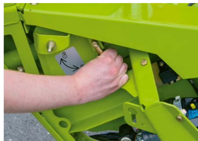
Zajištění děličů a dělicí kosa pro sklizeň řepky bez použití nářadí pomocí rychloupínání
