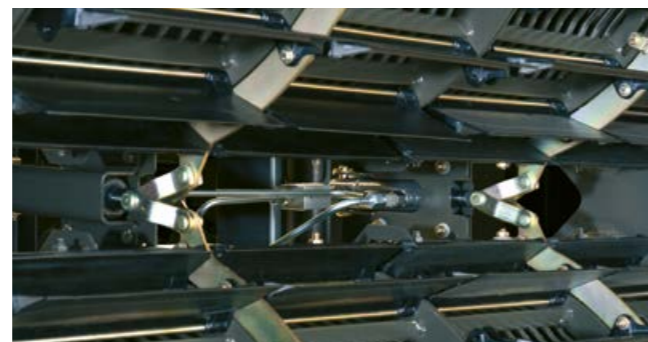
Hydraulicky přestavitelné klapky rotorů pro úpravu separační plochy rotoru.
