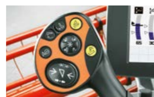
Automatické žací ústrojí aktivujete jednoduše tlačítkem pro regulaci výšky, umístěným na multifunkční páce.
