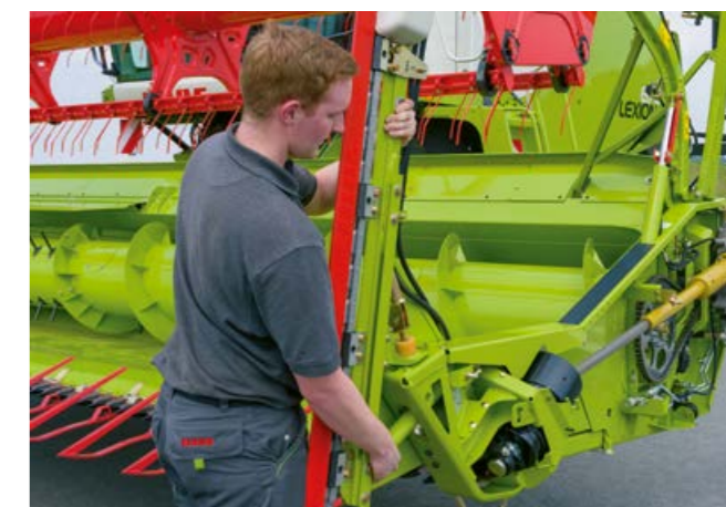
Připojení řepkového děliče přes rychloupínání
