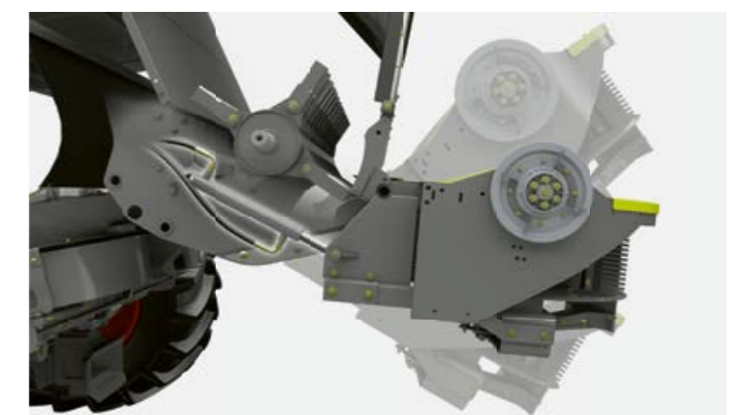
Pozice radiálního rozhazovače: přeprava, řezání, ukládání do řádků
