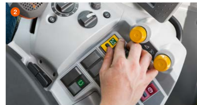
Možná reverzace vkladacího ústrojí s CMOTION (1) nebo s kolébkovým spínačem (2).
