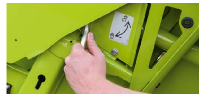
Zajištění děliče bez použití nářadí přes rychloupínání
