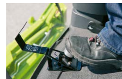
Uzávěrka diferenciálu umožňuje bezpečnou jízdu vpřed i v mimořádně strmém terénu. Dodatečnou jistotu nabízí mokrá hydraulická lamelová brzda.
