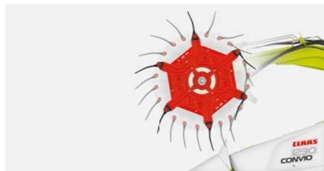
Přiřaněč je řízen kulisou s vodící dráhou Flip-Over
