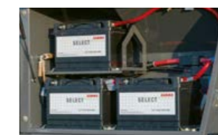
Dvě baterie pro 24-V elektroniku motoru, jedna baterie pro 12-V palubní elektroniku
