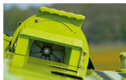
Pro volný výhled: odsávání prachu na šikmém dopravníku
