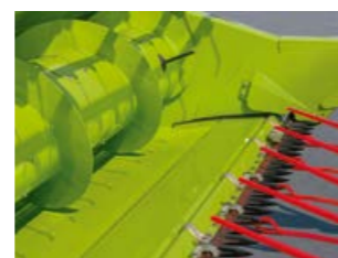
Vysunutí stolu žacího ústrojí – obilí (+ 100 mm)
