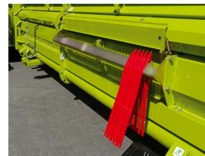
Praktické uchycení pro přidavné zvedáky na žací ústrojí
