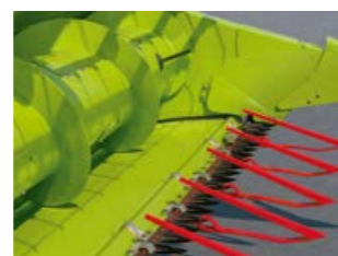
Zasunutí stolu žacího ústrojí – obilí (- 100 mm)
